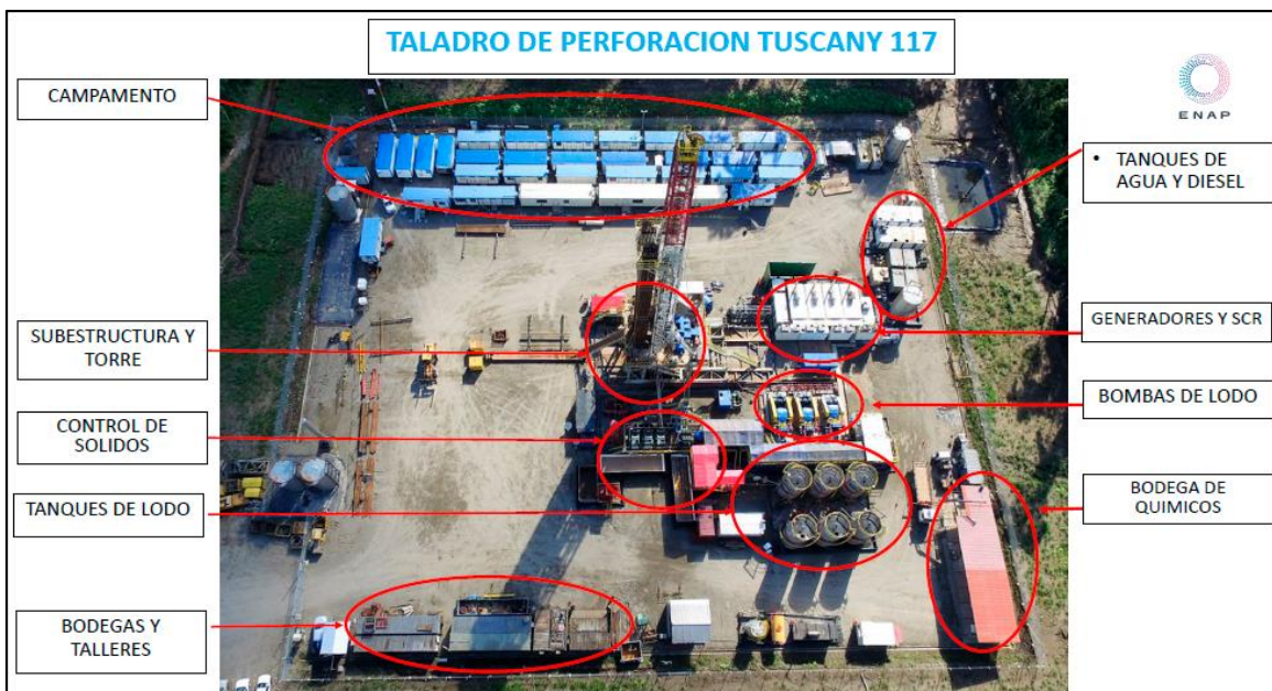
Figura 4 - 27. Plataforma Tipo de Perforación
