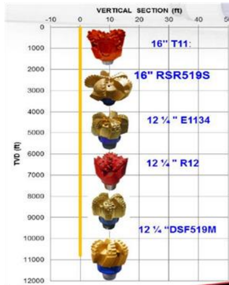
Figura 4 - 22. Brocas a utilizarse durante la perforación
